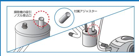
『蒸気回収タンク突起部 (グレー)』に掃除機の吸引ノズルを 差し込みます。
