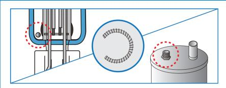
『アイロン台底面にある突起金具』と『蒸気回収タンク突起部(黒)』を付属のホースで接続します。
